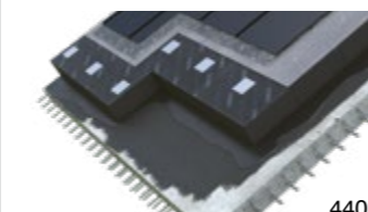
DEK STŘECHA ST.4006A ŽB, DHV AP, pěnosklo nad nos. konst., REI 60
