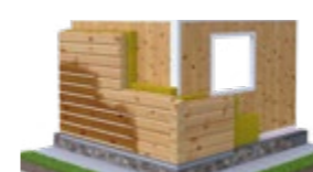
DEK OBVODOVÁ STĚNA SN.5001C DEKPANEL, s roubením, s vloženou izolací, MW, biodeska / dřevěné roubení
