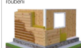
DEK OBVODOVÁ STĚNA SN.5001D DEKPANEL, s roubením, s vloženou izolací, MW, SDK + malba / dřevěné roubení
