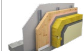
DEK OBVODOVÁ STĚNA SN.0005A DEKPANEL, zat. sys. větráný, dřevovláknno, SDK + malba / obklad z dřev. palubek
