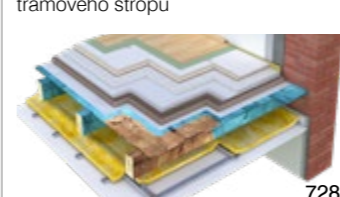
DEK PODLAHA PD.4501A na stropě, dřevovláknno, SVD, laminát, suchý provoz, rekonstrukce trámového stropu
