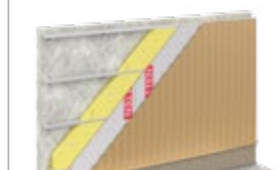
DEK FASÁDNÍ SYSTÉM TI.4006A větraný, běžná plocha, jednosměrný rošt, MW, obklad z trap. plechu
