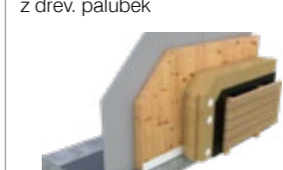
DEK VNITŘNÍ NOSNÁ STĚNA SN.0008B DEKPANEL, SVD + malba / biodeska
