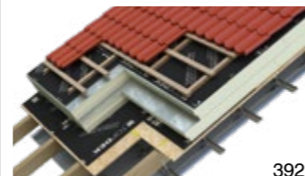
DEK STŘECHA ST.8003A krokve, DHV lehká fólie, MW + PIR mezi a pod nos. konst., REI 15
