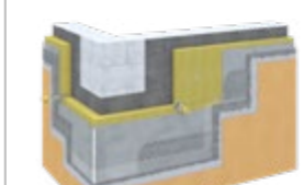
DEK FASÁDNÍ SYSTÉM TI.4205A ETICS, běžná plocha, MW, tenkovrstvá omítka
