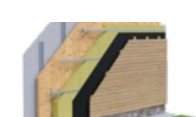
DEK VNITŘNÍ NOSNÁ STĚNA SN.0007C DEKPANEL, se spřaženou předstěnou, MW, SVD + malba
