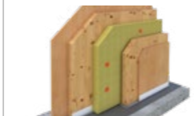
DEK VNITŘNÍ NOSNÁ STĚNA SN.0010B DEKPANEL, dvojitá, MW, biodeska
