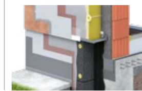
DEK FASÁDNÍ SYSTÉM TI.4006A větraný, běžná plocha, jednosměrný rošt, MW, obklad z trap. plechu
