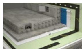
DEK IZOLACE SPODNÍ STAVBY HI.7001A vodorovná, hydroiz. a protirad. vrstva z 2x natav. AP, s obvodovou drenáží
