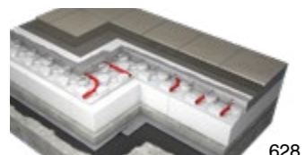
DEK PODLAHA PD.2005A na terénu, EPS, podl. potěr, laminát, suchý provoz, s teplovodním podl. vyt.
