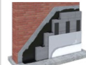
DEK PŘEDSTĚNA TI.8202A pěnosklo, SDK + malba
