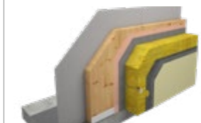
DEK OBVODOVÁ STĚNA SN.0006A DEKPANEL, zat. sys. větráný, dřevovláknno, SVD + malba / obklad z dřev. palubek
