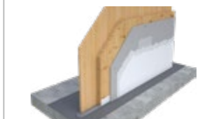
DEK OBVODOVÁ STĚNA SN.5001D DEKPANEL, s roubením, s vloženou izolací, MW, SDK + malba / dřevěné roubení
