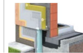
DEK FASÁDNÍ SYSTÉM TI.4007B větraný, běžná plocha, jednosměrný rošt, MW, obklad z cementovlákná
