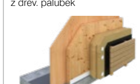
DEK VNITŘNÍ NOSNÁ STĚNA SN.0009A DEKPANEL, s volně stojící předstěnou, MW, SVD + malba
