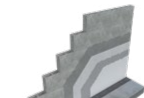
DEK PŘÍČKA SN.8002A interiér, 2× SDK, EI 30, tl. 155 mm
