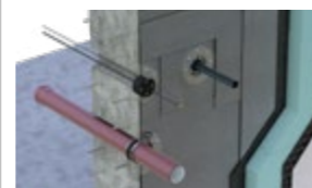
DEK IZOLACE SPODNÍ STAVBY ZD.2001B vodorovná, hydroiz. a protirad. vrstva z fólie PVC-P
