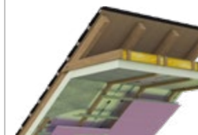
DEK PODHLED PH.1009B interiér, SDK, EI 15, přímo montovaný
