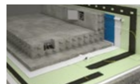
DEK IZOLACE SPODNÍ STAVBY HI.7002B svislá, hydroiz. a protirad. vrstva z 2x natav. AP, s obvodovou drenáží
