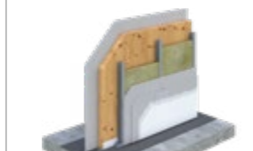
DEK OBVODOVÁ STĚNA SN.5001B DEKPANEL, s roubením, s vloženou izolací, MW, palubky / dřevěné roubení
