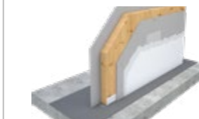
DEK VNITŘNÍ NOSNÁ STĚNA SN.0010B DEKPANEL, dvojitá, MW, biodeska
