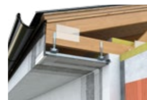
DEK PODHLED PH.1003A exteriér, cementovláknité desky, tenkovrstvá omítka, přímo montovaný
