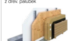
DEK VNITŘNÍ NOSNÁ STĚNA SN.0008A DEKPANEL, SVD + malba
