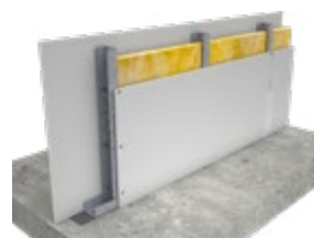
DEK PŘÍČKA SN.8003A interiér, 2× SVD, EI 90, tl. 120 mm
