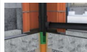
DEK IZOLACE SPODNÍ STAVBY ZD.2001A vodorovná, hydroiz. a protirad. vrstva z AP
