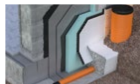
DEK IZOLACE SPODNÍ STAVBY HI.7202B svislá, hydroiz. z vodotěsnicí konst. s doplňkovou a protirad. vrstvou z HDPE
