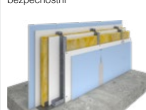
DEK PŘÍČKA SN.8004A interiér, 2× SDK, EI 90, tl. 167,5 mm, bezpečnostní
