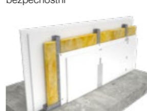
DEK PŘÍČKA SN.8006A interiér, 2× SDK, EI 60, tl. 100 mm, bezpečnostní
