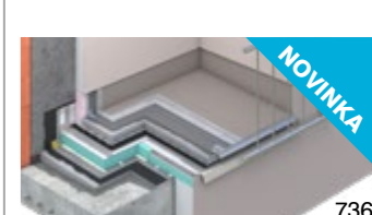
DEK PODLAHA PD.6001A na balkónu/lodžii, PU stěrka
