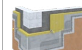
DEK SOKL TI.1803A ETICS, sokl, pěnosklo, tenkovrstvá omítka
