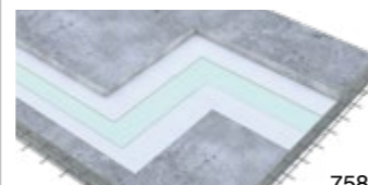
DEK IZOLACE SPODNÍ STAVBY HI.7005B svislá, hydroiz. a protirad. vrstva z 2x AP
