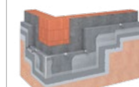
DEK FASÁDNÍ SYSTÉM TI.4204A ETICS, běžná plocha, MW, obklad z keram. pásků
