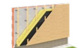
DEK FASÁDNÍ SYSTÉM TI.4008A větraný, běžná plocha, jednosměrný rošt, MW, obklad z dřev. palubek
