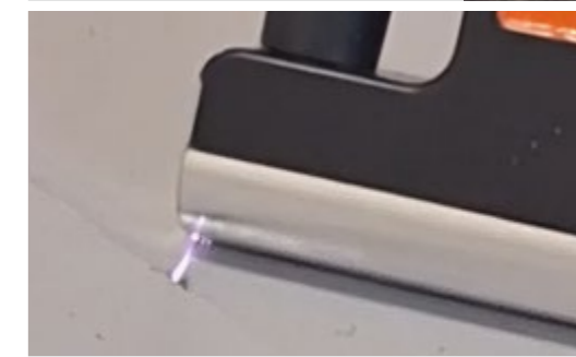
Detekce netěsnosti hydroizolační fólie podložené textilií FILTEK V CONTROL – jiskra v místě netěsnosti
