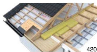
DEK STŘECHA ST.8004E nosníky a pórobet. vložky, DHV lehká fólie, PIR nad nos. konst., REI 30
