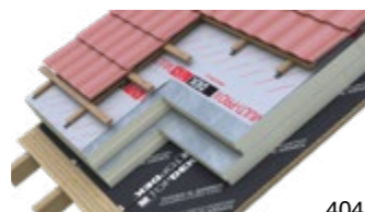
DEK STŘECHA ST.8006D příhradové vazníky, DHV lehká fólie, MW mezi a pod nos. konst., REI 15
