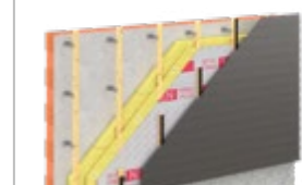
DEK FASÁDNÍ SYSTÉM TI.4007B větraný, běžná plocha, jednosměrný rošt, MW, obklad z cementovlákná
