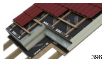
DEK STŘECHA ST.8003B krokve, DHV lehká fólie, MW + PIR mezi a pod nos. konst., REI 45
