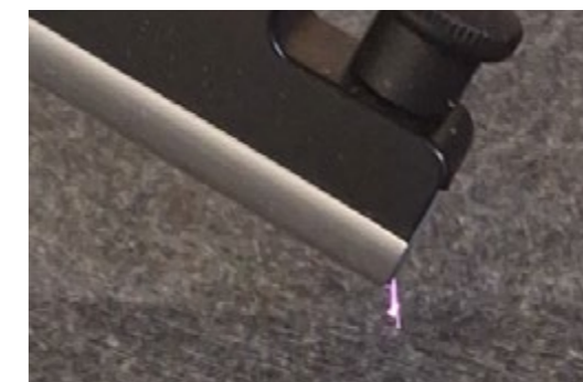
Elektrická vodivost FILTEK V CONTROL
