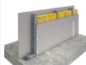
DEK PŘÍČKA SN.8004A interiér, 2× SDK, EI 90, tl. 167,5 mm, bezpečnostní
