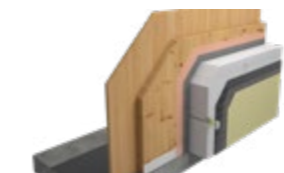
DEK OBVODOVÁ STĚNA SN.0011A DEKPANEL, zat. sys. větráný, MW, SVD + malba / obklad z dřev. palubek
