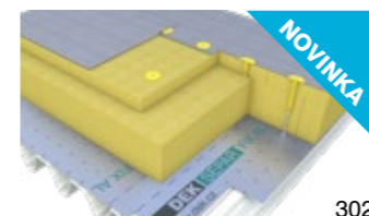
DEK STŘECHA ST.1022A 2x natav. AP, MW, trap. pl. ve spádu, kotvení, REI 60 DP3
