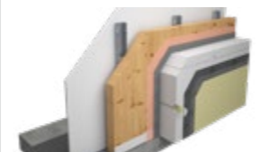
DEK OBVODOVÁ STĚNA SN.0001A DEKPANEL, ETICS, EPS, SDK + malba / tenkovrstvá omítka
