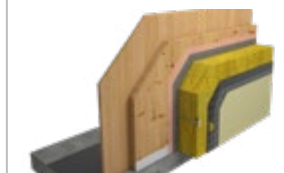
DEK OBVODOVÁ STĚNA SN.0006B DEKPANEL, zat. sys. větráný, dřevovláknno, biodeska / obklad z dřev. palubek
