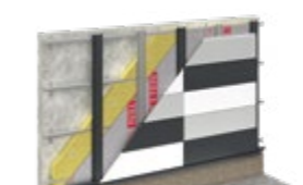
DEK FASÁDNÍ SYSTÉM TI.4008A větraný, běžná plocha, jednosměrný rošt, MW, obklad z dřev. palubek
