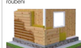
DEK OBVODOVÁ STĚNA SN.5001B DEKPANEL, s roubením, s vloženou izolací, MW, palubky / dřevěné roubení
