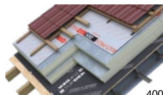
DEK STŘECHA ST.8006B příhradové vazníky, DHV lehká fólie, MW + PIR mezi a pod nos. konst., REI 15
