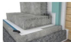
DEK IZOLACE SPODNÍ STAVBY HI.7202B svislá, hydroiz. z vodotěsnicí konst. s doplňkovou a protirad. vrstvou z HDPE
