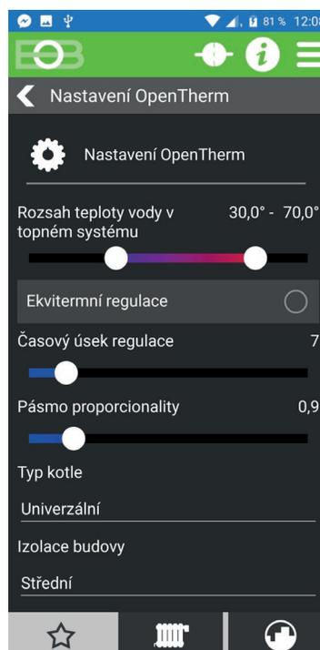
**Časový úsek regulace** - volí se podle teplotní setrvačnosti objektu. Optimální nastavení bývá 10 až 15 min. Volitelný rozsah 5 min až 20 min (po 1min).
