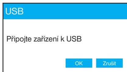
Při výzvě připojte centrální jednotku k PC pomocí mini-USB kabelu a klikněte na OK.
