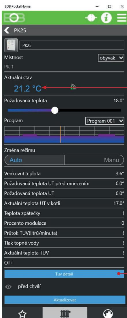
Po připojení externího čidla k centrální jednotce zobrazuje aktuální teplotu v místnosti.
