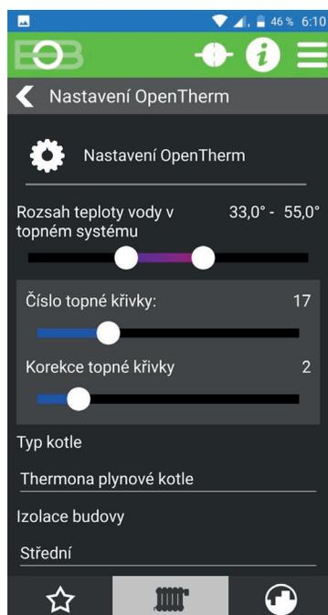
**Teplota vody v topném systému** - určuje minimální a maximální teplotu vody v topení. Pokud je vypočtená teplota vody menší jak minimální nastavená, dojde k vypnutí kotle. Systém nedovolí překročit maximální nastavenou hodnotu. Volba izolace budovy má vliv na chování systému. Zvolte požadovanou křivku a posun v závislosti na venkovní teplotě (ekvitermní regulace). Tvar křivky pro regulace elektrobock lze zobrazit na: <https://history.elektrobock.cz/Equitherm>
