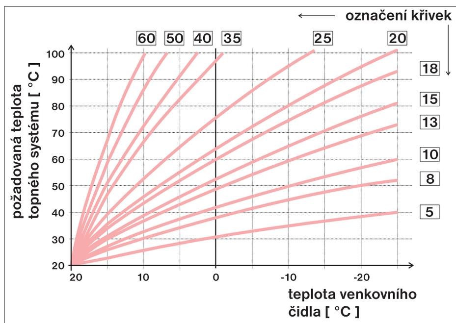
Pokud zvolíte požadovanou teplotu místnosti jinou než 20°C, termostat vypočítává automatický posun křivky podle následující rovnice, kde koeficient je 1:  $\text{posun} = (\text{požadovaná teplota} - 20) * \text{koeficient} / 2$
