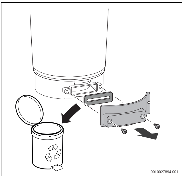
Obr. 68 Otevření revizního otvoru
