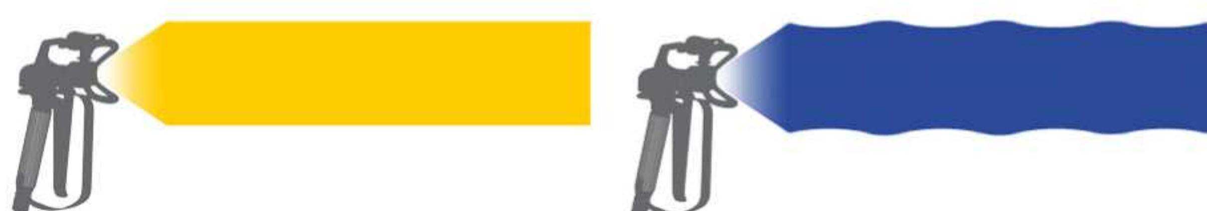
Při nízkém tlaku: pravidelný nástřik z membránového zařízení (žlutě) a částečně nepravidelný z pístového (modře)
