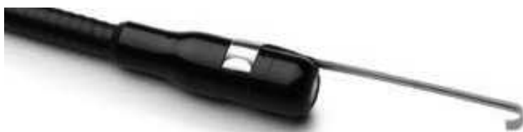
Obrázek 9 – Instalace příslušenství na zobrazovací zařízení opatřené konektorem v provedení „A“
