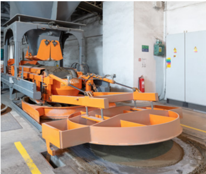
Proces výroby polotovaru systémem vibrolisování
