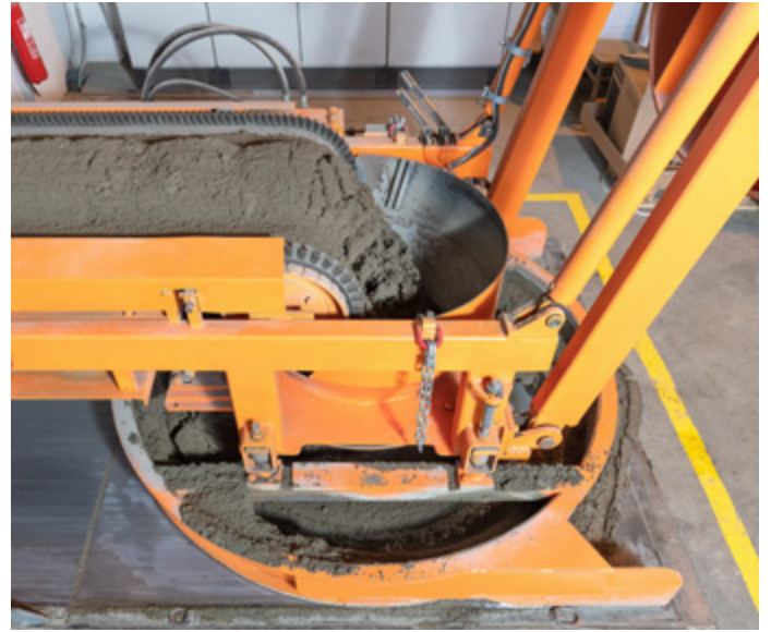
Plnění formy jemnozrnným betonem s nízkým vodním součinitelem
