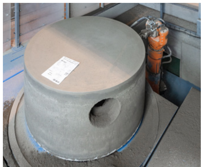
Samotné frézování kynety a vstupu do šachty proběhne v řádu jednotek minut
