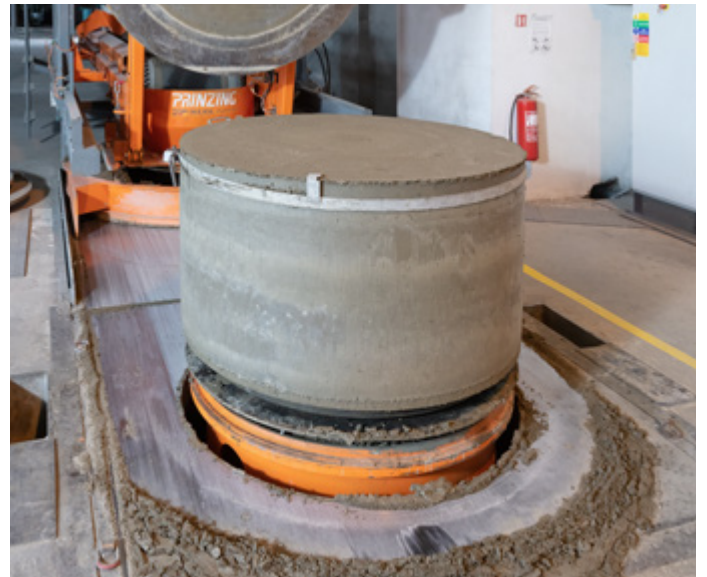
Hotový vibrolisovaný polotovar šachtového dna – výroba v obrácené poloze
