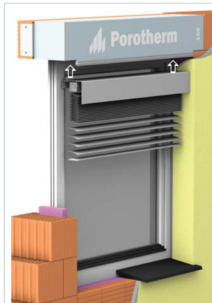
Překlad Porotherm KP Vario UNI 100 až 175 – řešení se žaluzií
