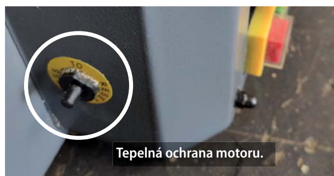
9. Tepelná ochrana motoru. Při přetížení nebo přehřátí motoru vypne stoj tepelná ochrana. Pro opětovné spuštění stroje počkejte několik minut až motor vychladne a poté zamáčkněte tlačítko tepelné ochrany.
