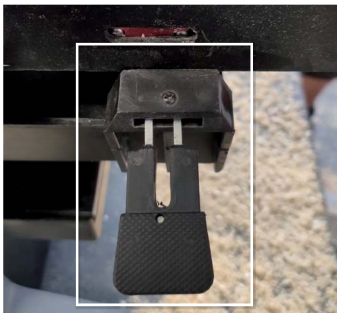
2. V této pozici je koncový spínač neaktivní.
