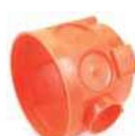
**PDM**, krabica pre systém Perilex; oranžová (RAL 2004), rozpätie skrutiek 67mm, vhodná pre kombinácie, pre vložky Perilex 16A, montážna hĺbka 62mm, max. pripojenie 6 rúrok do Ø 25mm a 2 rúrok do Ø 20mm
