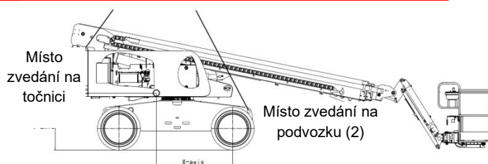
Obrázek 10-5 Schéma uchycení pro zvedání stroje
