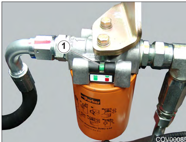
Obrázek 9.18 – Typický zpětný filtr hydraulického systému
