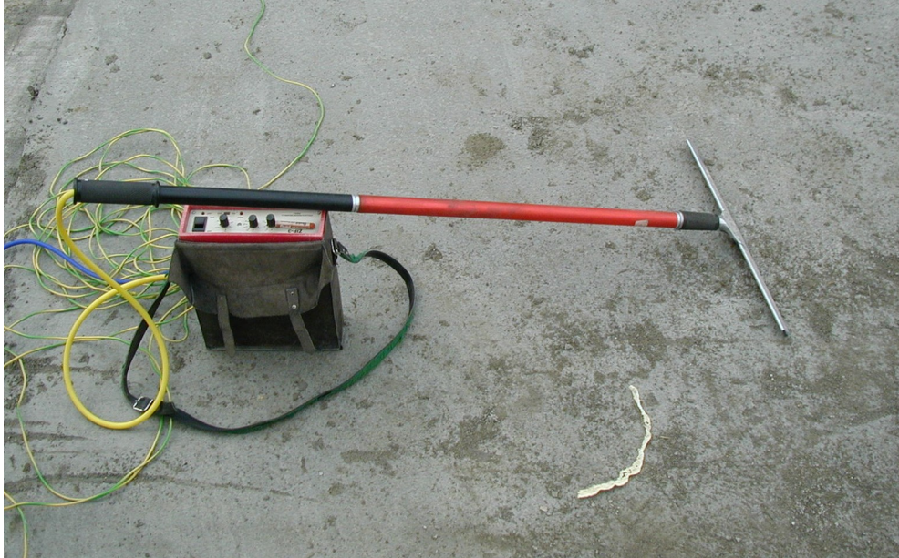
Foto 8. Poroskop - přístroj pro provádění jiskrové zkoušky.
