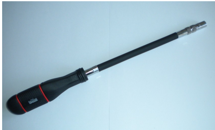
Foto 6. Ohebný šroubovák 6/7 mm k systému DUALDEK na dotažení objímek
