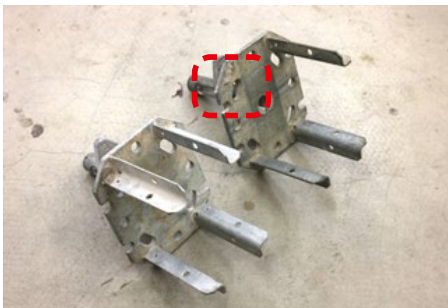
Čtyřcestné spouštěcí hlavice s chybějícími úhelníky jsou nepřipustné. Takové hlavice se nesmí používat k bednění.
