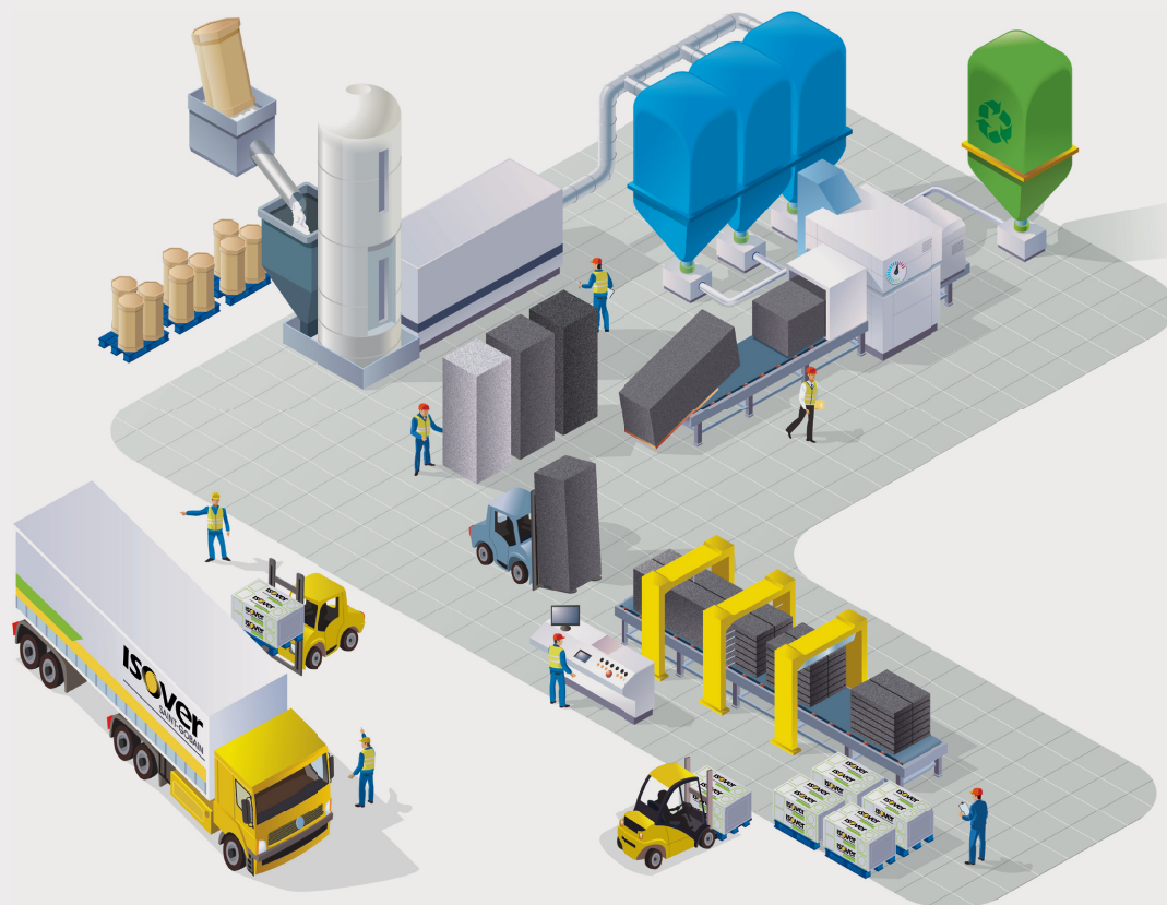
Obr. 3 - Schéma výroby pěnového polystyrenu
