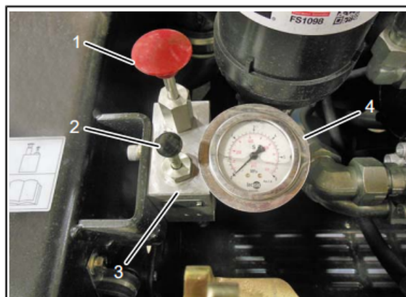
Obr. 4-60 Uvolňovací ventil parkovací brzdy
