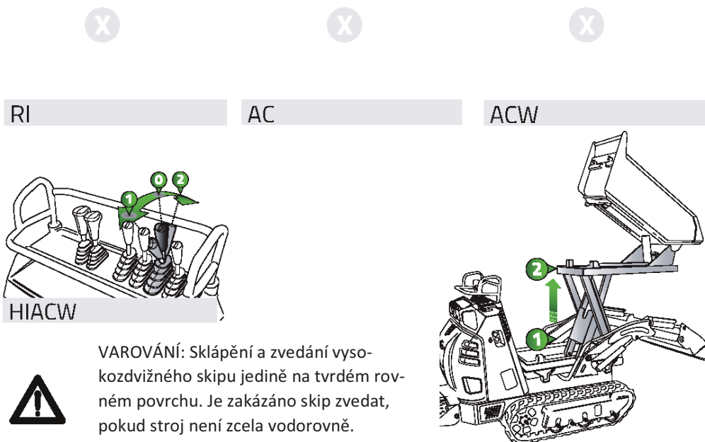
Obr. 15 – Páka pro rotační zdvih lžíce (nahore) a vyklápění (dole)
