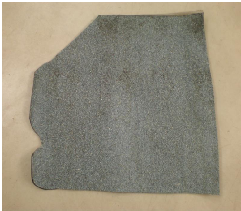
Obrázek /20/ Speciální tvar asfaltového pásu s posypem přivedeného po atice k detailu vnějšímu rohu
