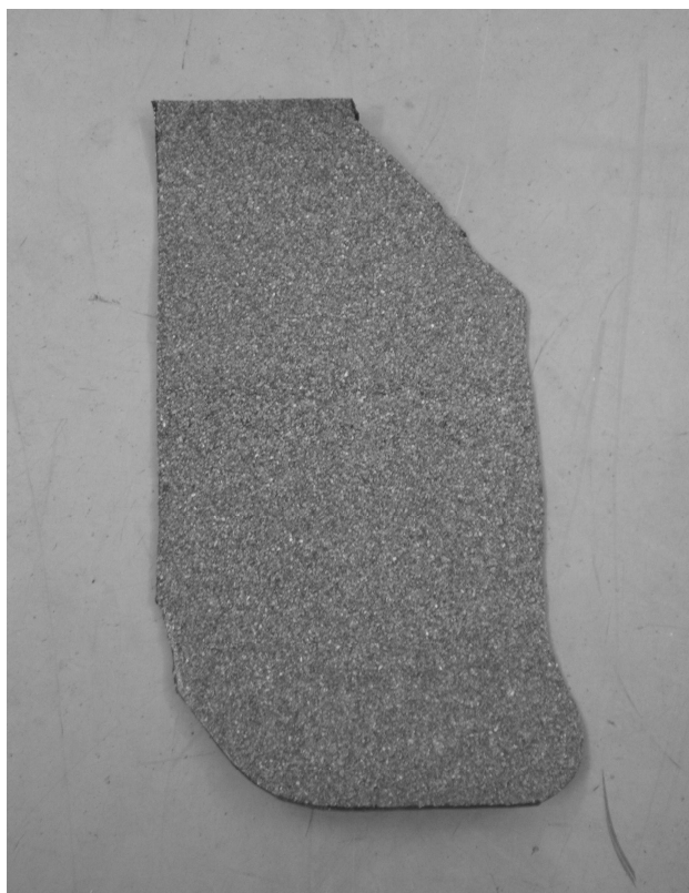
Obrázek /26/ Speciální tvar asfaltového pásu s posypem na atice mezi vnitřním koutem a vnějším rohem
