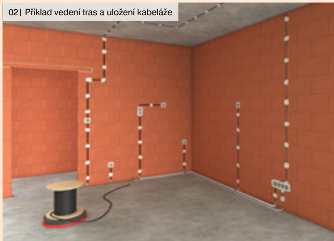
02 | Příklad vedení tras a uložení kabeláže
