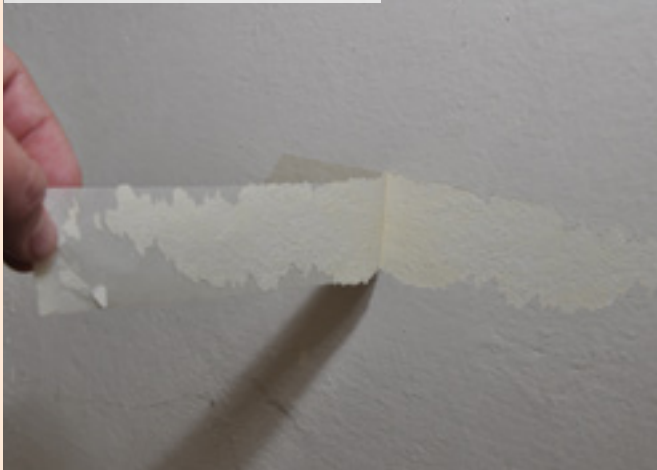
03 | Polní zkouška soudržnosti vrstev výmalby
