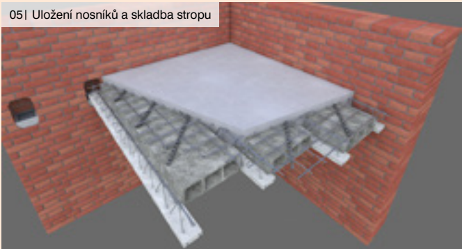
05| Uložení nosníků a skladba stropu
