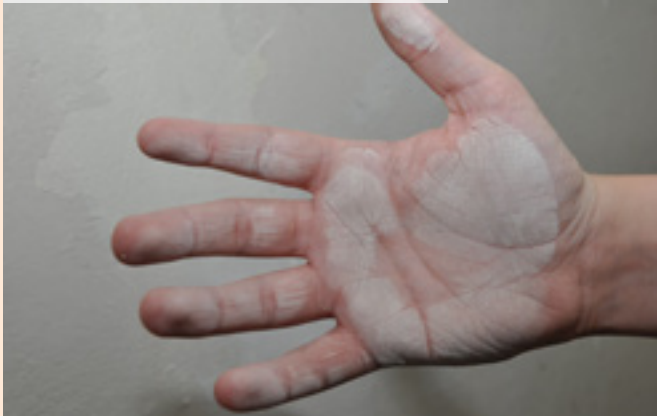
03 | Polní zkouška soudržnosti vrstev výmalby
