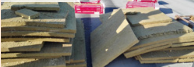
03| Odstraněná tepelná izolace
