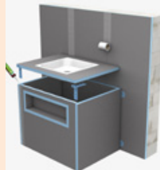
03 | Utěsnnění spoje lepidlem
