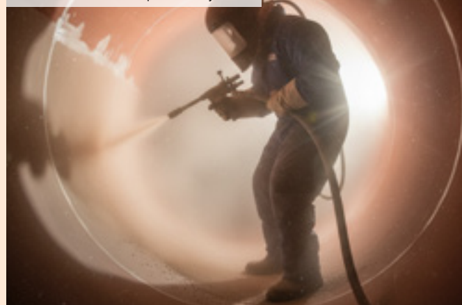
05| Zdrsňení ocelového podkladu tryskáním
