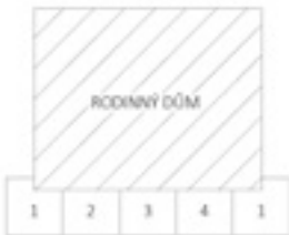
05| Rozdělení stavebních jam pod původní základy na sekce
