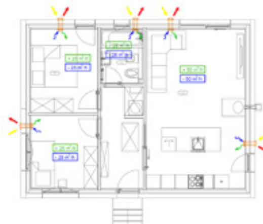
02 | Příklad návrhu větracího systému
