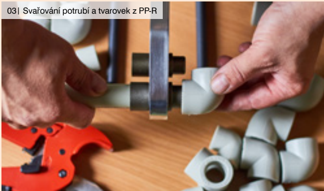
03| Svařování potrubí a tvarovek z PP-R
