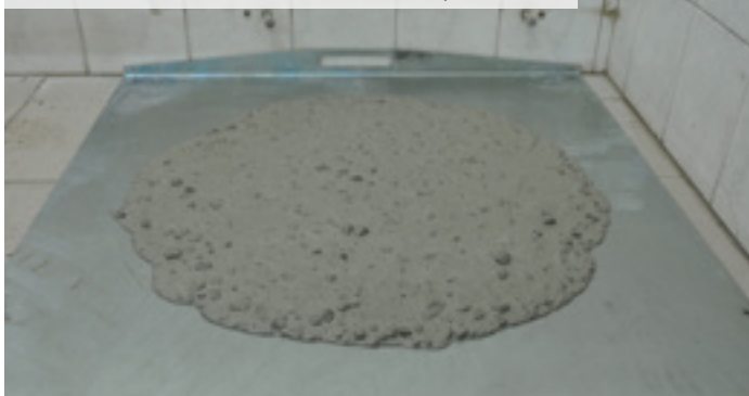
04 | Zkouška konzistence betonu rozlítím – směs s plastifikátorem
