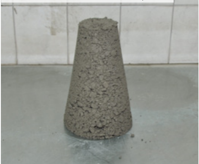
03 | Zkouška konzistence betonu sednutím kužele – směs bez plastifikátoru
