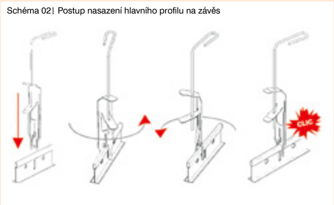
Schéma 02| Postup nasazení hlavního profilu na závěs
