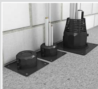
Kombinace kabelů a trubek až do plného osazení. Lze také uspořádat do skupin se vzdáleností 205 mm (DS 90 / 120 mm) nebo 125 mm (DS 90 / 74 mm).
