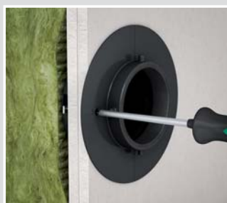
Válec průchodky se upevňuje stejně jako krabice do dutých stěn utažením patkových šroubů.
