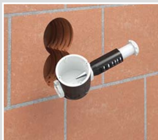
Protipožární krabice pod omítku nabízí 6 možných prostupů pro trubky do velikosti M25 a pro vedení do \varnothing 11,5 mm.
