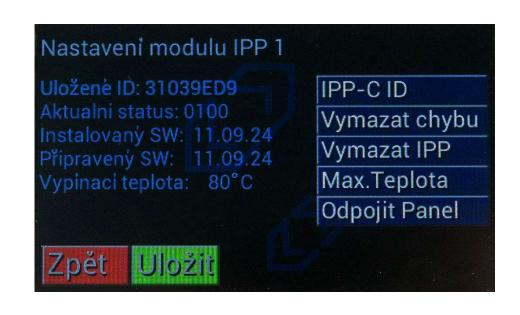
Po odstranění případného problému s modulem může technik vymazat chybu pomocí tlačítka "Vymazat chybu".
