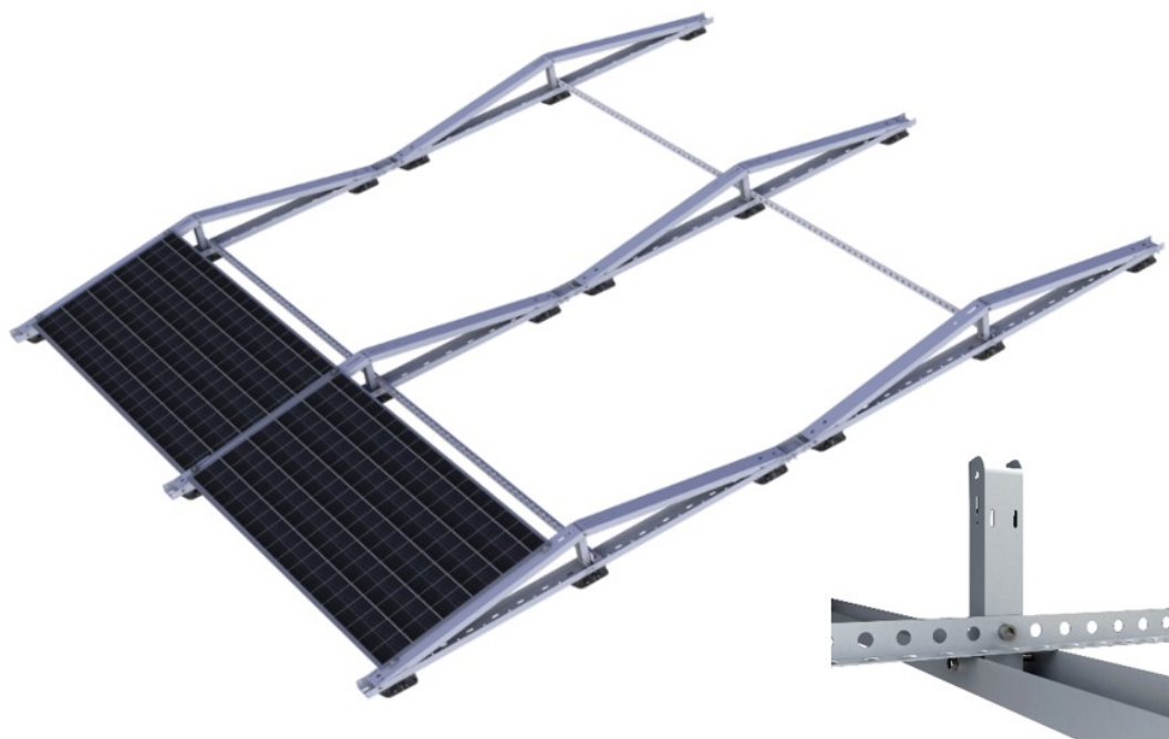
obr. 3: rozložení sestavy konstrukce pro uchycení panelu za krátkou stranu vč. výztuhy – propojení L-profilem skrze stojky viz detail
