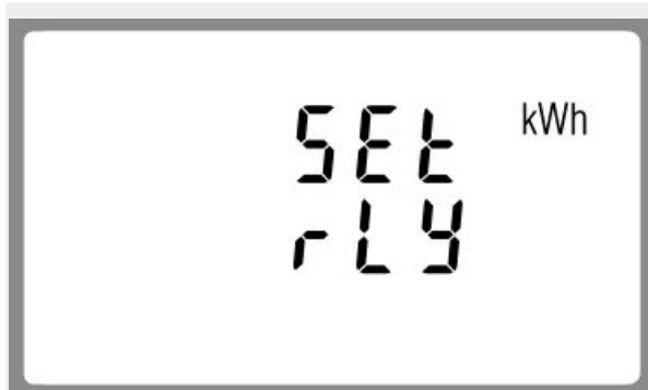
V nabídce nastavení použijte tlačítka a a vyberte volbu nastavení pulsního výstupu.
