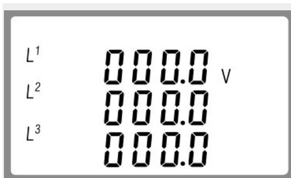
Napětí mezi fázemi a N vodičem.
