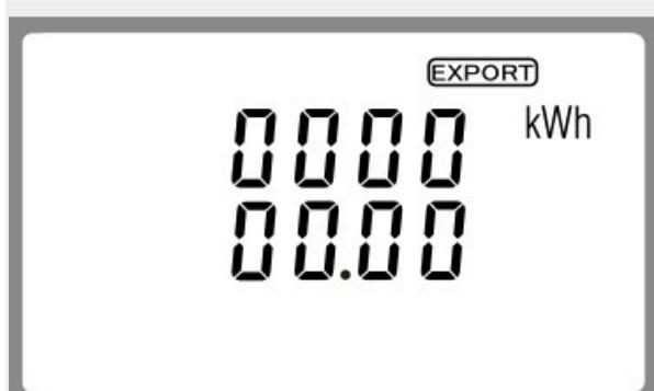
Přetok činné energie v kWh.
