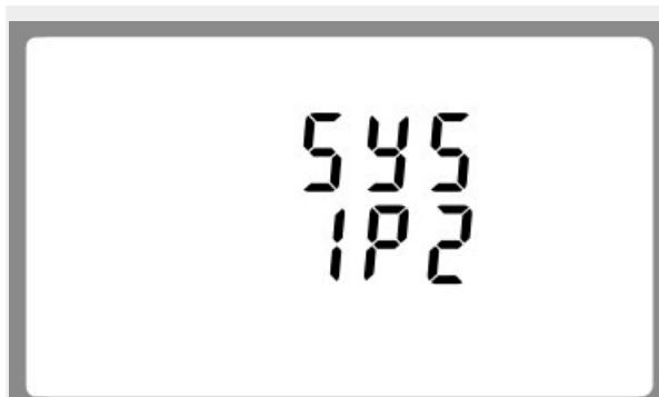
Požadovaný typ připojení vyberte pomocí tlačítek
