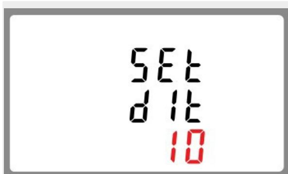
Stiskněte tlačítko **E** pro vstup do nastavení. Aktuální hodnota integračního času začne blikat.
