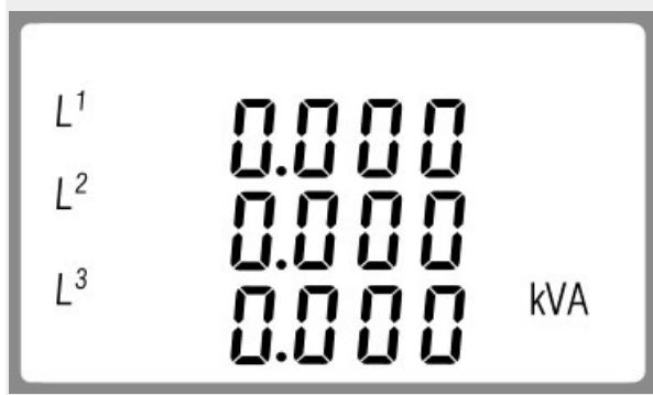
Okamžitý volt-ampérový výkon v kVA.
