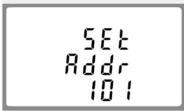
Pomocí tlačítek a nastavte požadovanou Modbus adresu (v rozsahu od 001 do 247).
