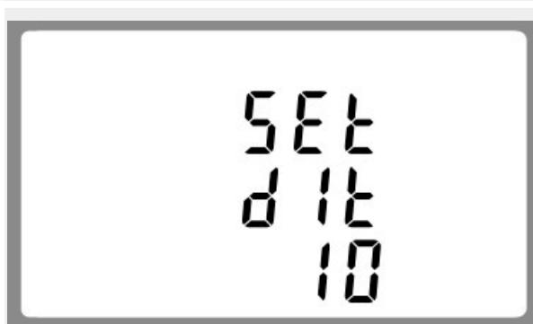
V nabídce nastavení použijte tlačítka **MDI/PF/HZ** a **P** a vyberte volbu DIT. Zobrazí se aktuálně nastavený integrační čas.
