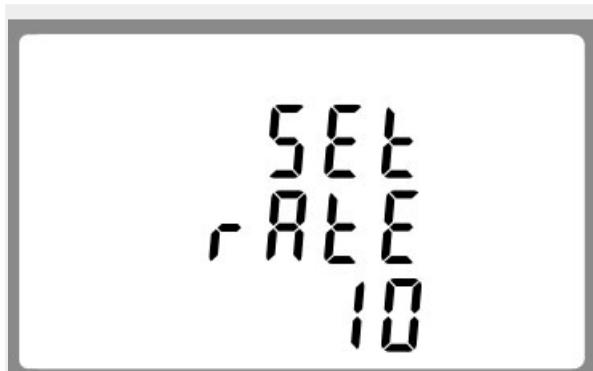
V nabídce nastavení použijte tlačítka a pro výběr změny pulsního poměru.
