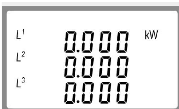
Okamžitý činný výkon v kW.
