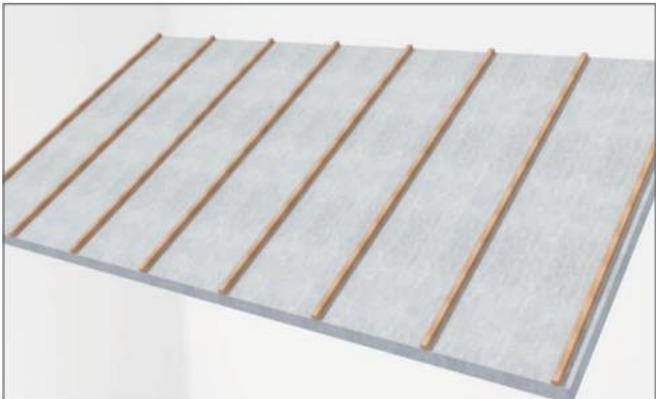
5-2-1.1 Instalace betonové střechy s kontralatovým latěním
