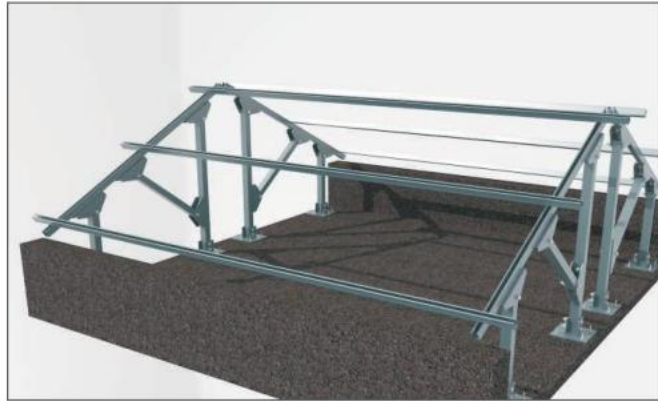
5-2-2.1 Ocelová konstrukce, instalace ocelových střešních podpěr z plochého na šikmý typ
