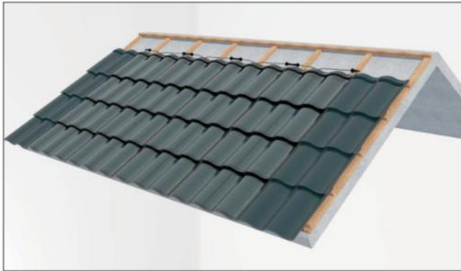
5-2-1.7 Instalace boční dlaždice z tašek Han na beton
