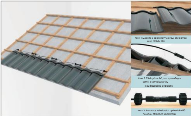
5-2-1.4 Instalace hlavních tašek Han na betonovou střechu
