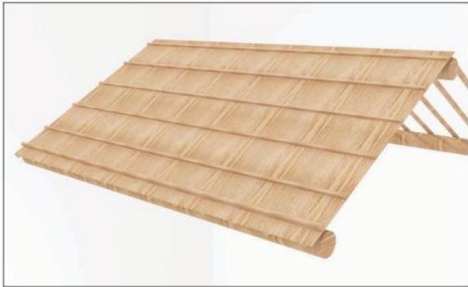
5-2-5.3 Montáž dřevěných střešních latí
