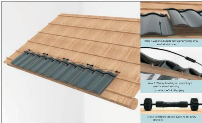
5-2-3.5 Konstrukce dřevěné střechy, tašek Han a údržba instalace tašek.
