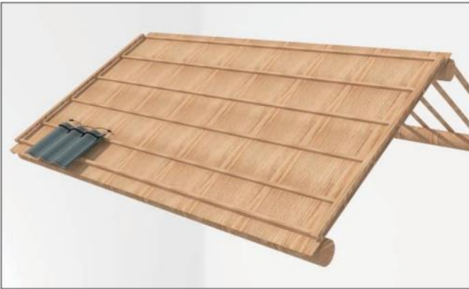
5-2-3.4 Konstrukce dřevěné střešní krytiny Han a pokládka hlavních tašek.
