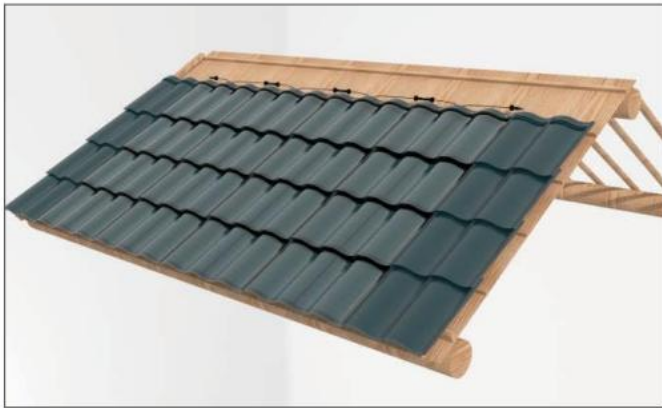
5-2-3.8 Instalace boční tašky Han na střechu dřevěné konstrukce
