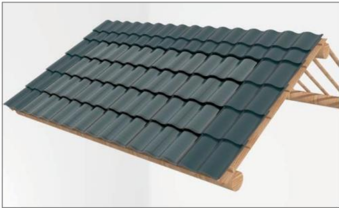
5-2-3.9 Instalace boční tašky Han na střechu dřevěné konstrukce
