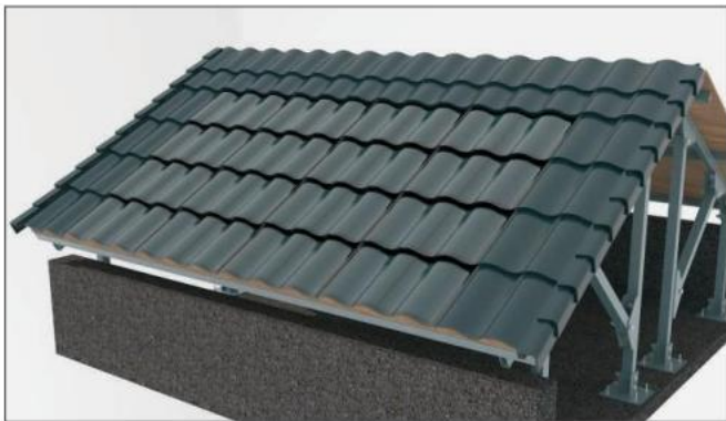
5-2-2.10 Instalace boční tašky Han na střechu z ocelové konstrukce nebo z plochého na šikmý střešní krytinu.
