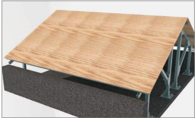
5-2-2.2 Ocelová konstrukce, vyrovnávací vrstva střechy s plochou až šikmou střechou (instalace nosné vrstvy)
