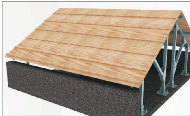
5-2-2.3 Montáž střešních latí ocelové konstrukce, střecha s plochou až šikmou střechou
