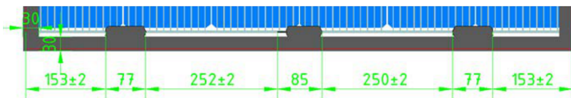
Obrázek 10. Poloha propojovací krabice u modulů SOLID Bifacial Framed B.60 35(40) mm.
