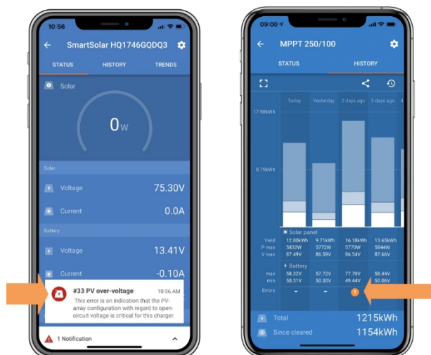
Aplikace VictronConnect: snímek obrazovky s chybou #33 a snímek historie indikující chybu
