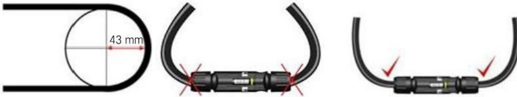
Obrázek 13. Správné vedení a minimální poloměr ohybu kabelů
