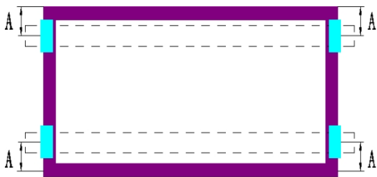
Obrázek H Na krátké straně použijte 4 svorky. Montážní lišty jsou umístěny kolmo k rámu na krátké straně rámu. (délka svorky \geq 50 mm)
