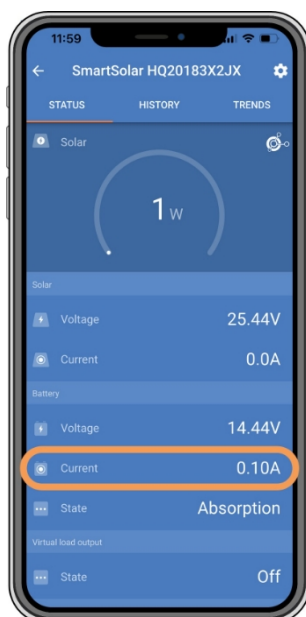
Aplikace VictronConnect ukazuje téměř nulový nabíjecí proud.
