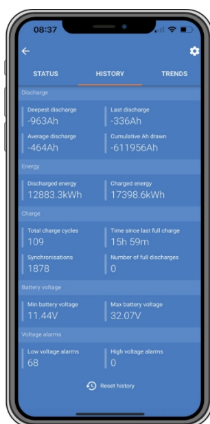
Aplikace VictronConnect zobrazující historii monitoru baterie
