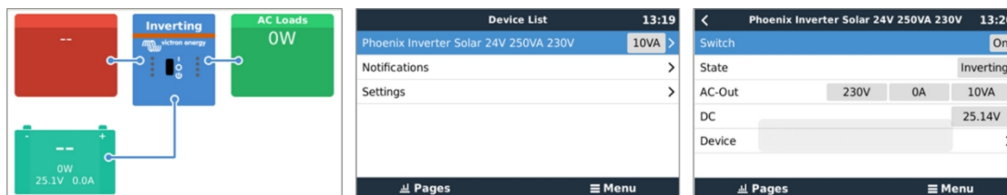
Příklad obrazovek GX zleva doprava: systémová obrazovka, seznam zařízení a obrazovka zařízení měniče.
