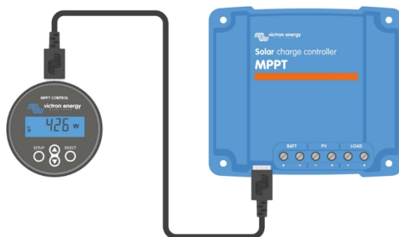
Připojení displeje k solární nabíječce pomocí kabelu VE.Direct
